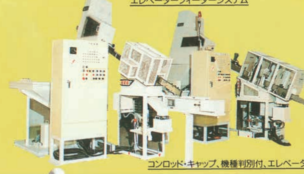
コンロッド前後選別合流機構付、エレベーターフィーダーシステム
