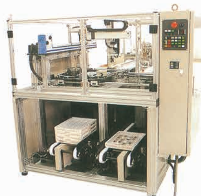
● 多段標準型パレット パレット (370×280×H40) 9段積 ワーク取出し高さ920m/m
